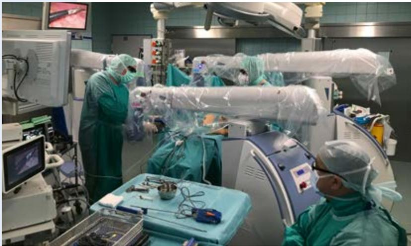
**Abbildung 1** OP-Situs bei einer Senhance®-Heminephrektomie mit drei angedockten Roboterarmen. Der Arm für den Zugang im rechten Unterbauch (rechte Hand des Operateurs) arbeitet „overhead“, da er aus Platzgründen patienten-linksseitig platziert ist, desgleichen der Arm für die linke Hand des Operateurs, bestückt mit einer monopolaren 5-mm-Maryland-Klemme. Der Kameraarm wurde patienten-rechtsseitig platziert (10 mm 3D-Olympus-Endoeye®).
